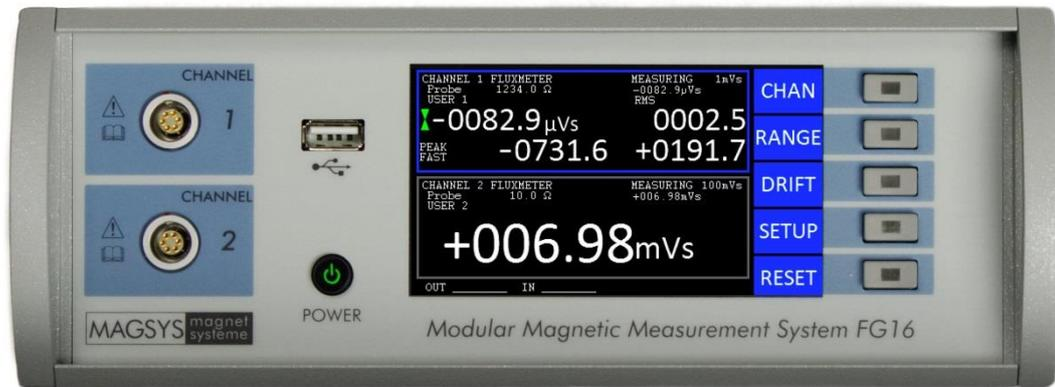
**Le FG16 est un appareil modulaire pour mesurer les valeurs magnétiques. Les 4 ports disponibles peuvent être équipés de modules enfichables pour le fluxmètre, le gaussmètre et fluxgates dans toutes les combinaisons possibles.**
