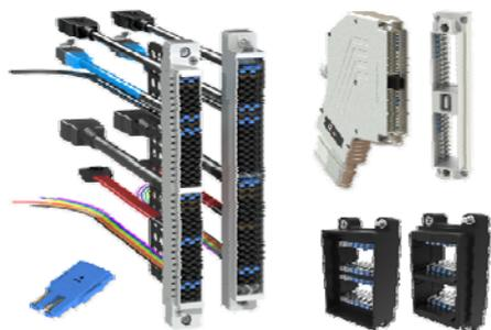
L'insert VTAC HSD permet un taux de transfert de données supérieur à 12.5 Gbps par paire différentielle, avec 2 paires différentielles par insert. Les contacts plaqués or, dotés d'un système d'alignement automatique ont été spécialement conçus pour minimiser la diaphonie et accroître l'intégrité des signaux durant les transferts à haute vitesse, tout en maximisant leur durée de vie. Chaque insert VTAC HSD a une durée de vie de 150 000 manœuvres, sans dégradation du signal.
