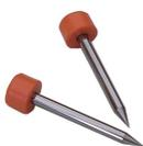
Les électrodes servent à créer à un arc électrique afin de fusionner les fibres entre-elles. Les ER-10 sont utilisées pour les soudeuses T-39 et T-25e.
