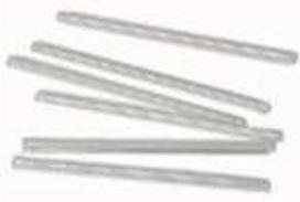
Les protections servent à protéger et à solidifier la soudure qui vient d'être réalisée. 4 modèles sont disponibles avec des longueurs de 40 mm et 61mm et des diamètres de 2,1 mm et 2,6 mm.
