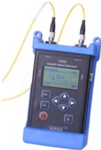
Les VOA5-MM (Multimode) et VOA5-SM (Monomode) sont des atténuateurs optiques robustes et compacts. Ils permettent de déterminer la marge des systèmes optiques, de vérifier la sensibilité des récepteurs et de tester les taux d'erreur bit (BER).
