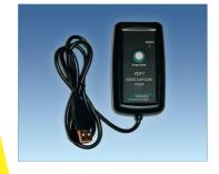
La sonde peut-être couplé, soit à l'écran LCD haute résolution VFS2 de 3,5 pouces, soit au module PCV 1, qui permet à l'utilisateur d'inspecter fibre optique et les connecteurs en visualisant et/ou sauvegardant les images sur un ordinateur.
