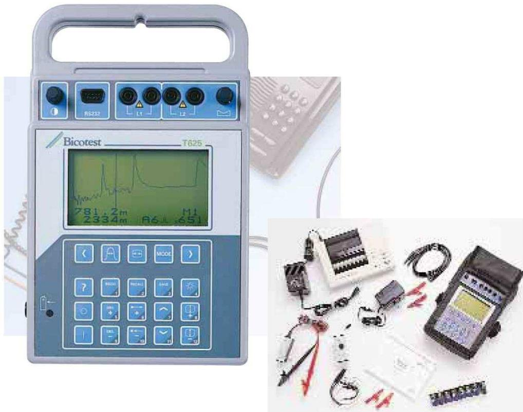
Il mesure depuis les courtes distances avec une précision de 0,5m, jusqu'au longue distance grâce à une impulsion max de 20V dont la largeur s'adapte automatiquement avec la gamme. Son excellente dynamique autorise une identification claire des défauts, même à la distance maximum de 20km.
