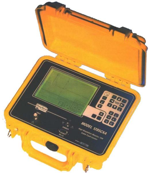
Le M1205CXA est un échomètre qui permet de localiser des défauts sur tous types de câbles coaxiaux et à paire torsadée. Ses performances permettent d'identifier tous les petits défauts qui « polluent » les systèmes haute fréquence et provoquent des interruptions du signal numérique.
